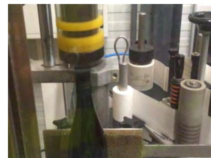
machine à opercule sur bouchon puis étiquette
