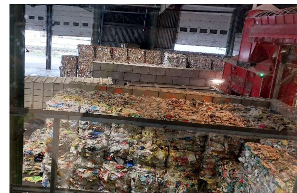
Conditionnement en balles après le tri des emballages
