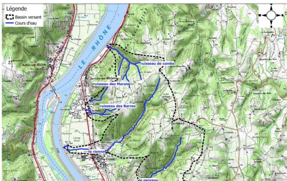
La Rionne est un affluent rive gauche du Rhône drainant un bassin versant d'environ 2.8km<sup>2</sup> pour un linéaire de 3.6 km. Elle prend sa source sur les hauteurs de la commune d'Erôme, à une altitude d'environ 340m et rejoint le contre canal CNR à une altitude voisine de 125m. Le gradient altitudinal est donc important.
